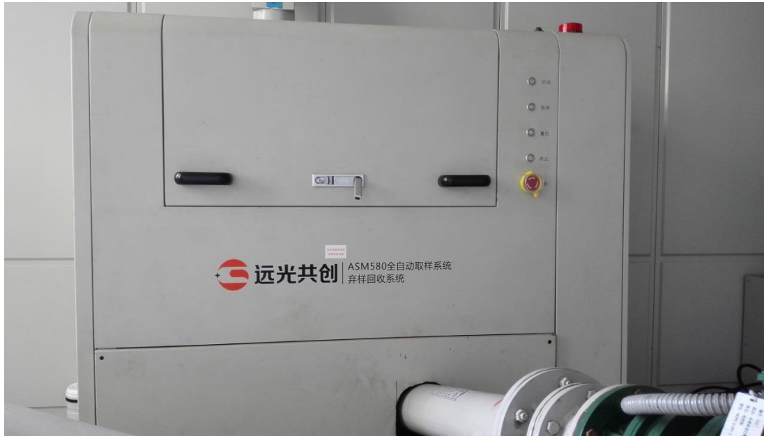
图5 弃料回收系统现场图
