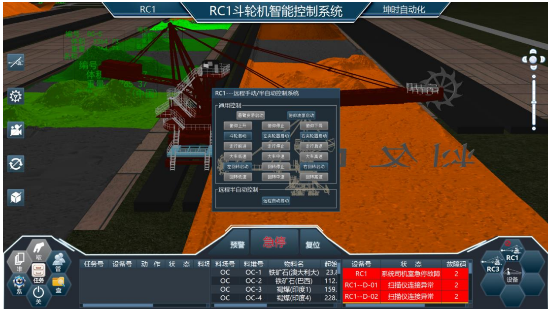
图28 具体斗轮机手动/半自动控制图
