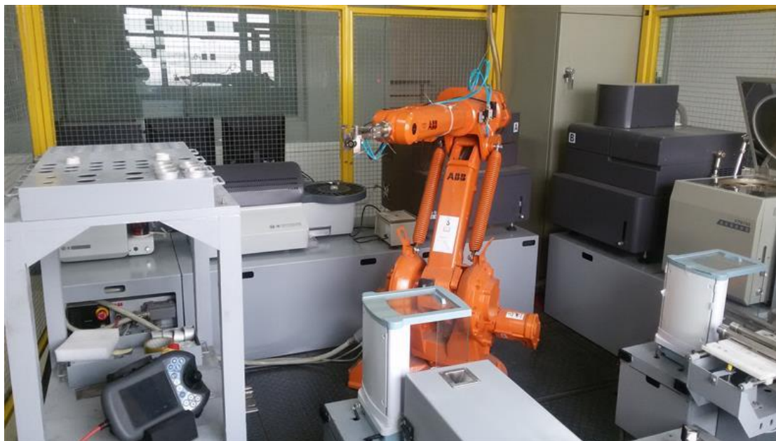
图23 机器人煤样分析
